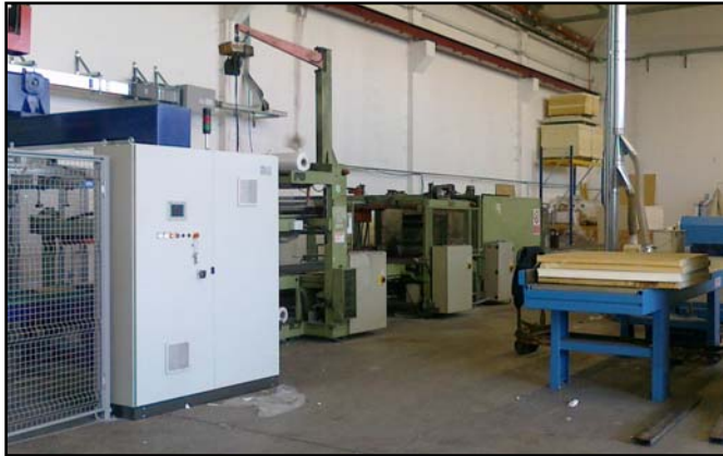
Battentatura, incastro M/F e taglio
