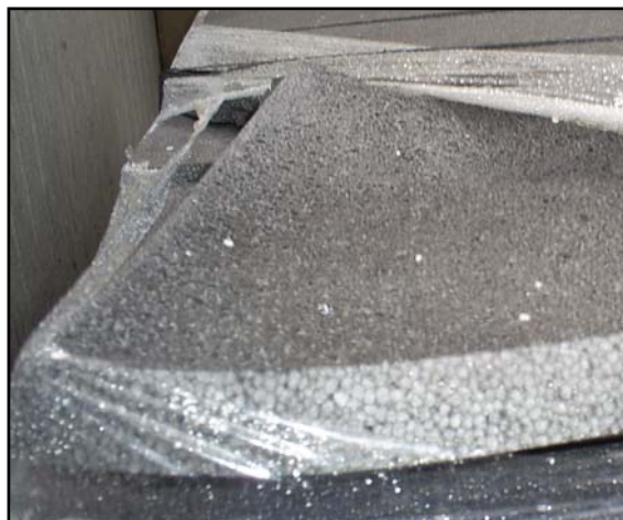
Polistirene espanso sinterizzato con grafite T_{\max} 70\text{ }^{\circ}\text{C}
