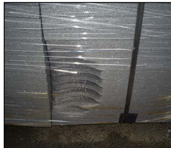
Polistirene espanso sinterizzato con grafite T_{\max} 70\text{ }^{\circ}\text{C}
