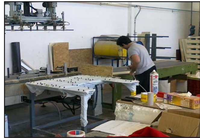
Assemblaggio mediante incollaggio
