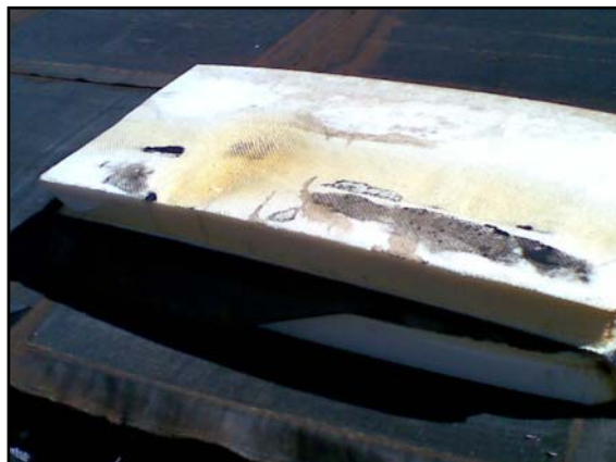
Polistirene espanso estruso T_{\max} 75\text{ }^{\circ}\text{C}
