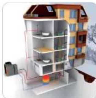
Esempio di applicazione pompa di calore ad assorbimento a gas aria-acqua E<sup>3</sup> A a caldaie a condensazione a gas A2: Condensing per:
