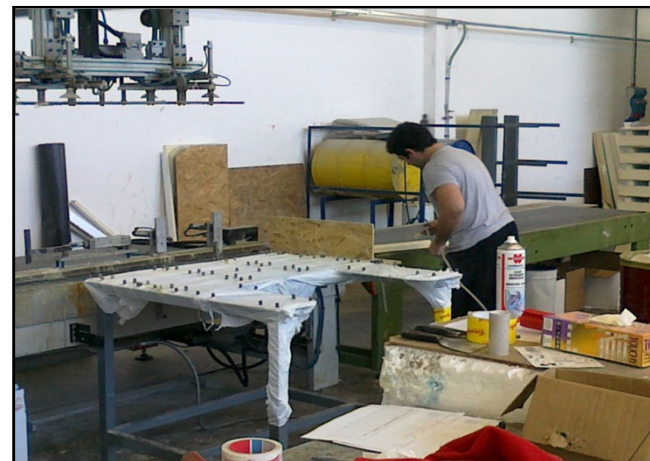
Assemblaggio mediante incollaggio
