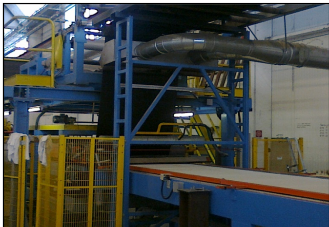
Preassemblaggio strato isolante- strato impermeabile
